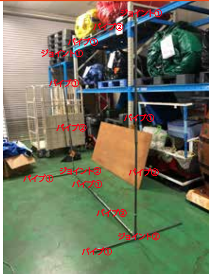
①パイプとジョイントを繋ぎ合わせて枠をつくります。
