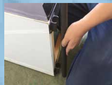
⑧側面パイプをスロープ板に差し込みます。
